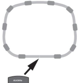
**Montage** Die Kupplung für das KLICKfix Lenkeradaptersystem darf nur an original Reisenthel Bikebaskets verwendet werden (5 kg max.). Stecken Sie die Kupplungsteile mittig auf die gerade Seite des Aluminium Bügels. Die 4 Schrauben von unten
