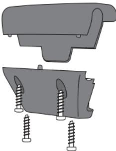
in das Kupplungsstück setzen und mit Kreuzschlitz Schraubendreher festziehen (1,5-2 Nm max.).
